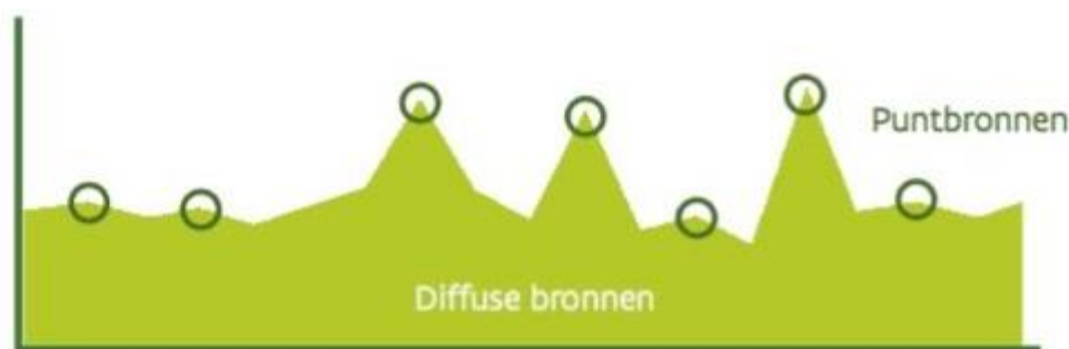
Figuur 10: Illustratie van het verschil tussen diffuse bronnen en puntbronnen langs een waterloop.
